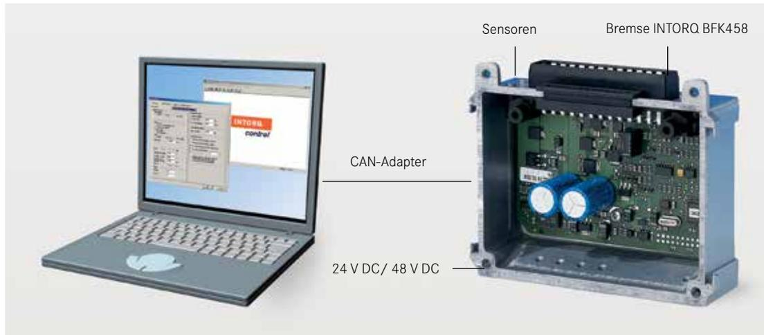
Das mechatronische Bremssystem ist geeignet für ein geregeltes Bremsen im Staplerbereich in batteriebetriebenen Fahrzeugen. Durch Kombination einer Federkraftbremse mit einer intelligenten Ansteuerung wird eine optimale lastabhängige Bremsmomentregelung (lastunabhängiger Anhalteweg) erreicht. Der Regelbereich liegt bei 20 % bis 100 % des Kennmomentes. Die Parametrierung der INTORQ Control erfolgt über die Windows Oberfläche.
